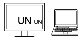
Lo stesso schermo sul monitor monitor e PC portatile (NG) (Mirroring / duplicazione)
